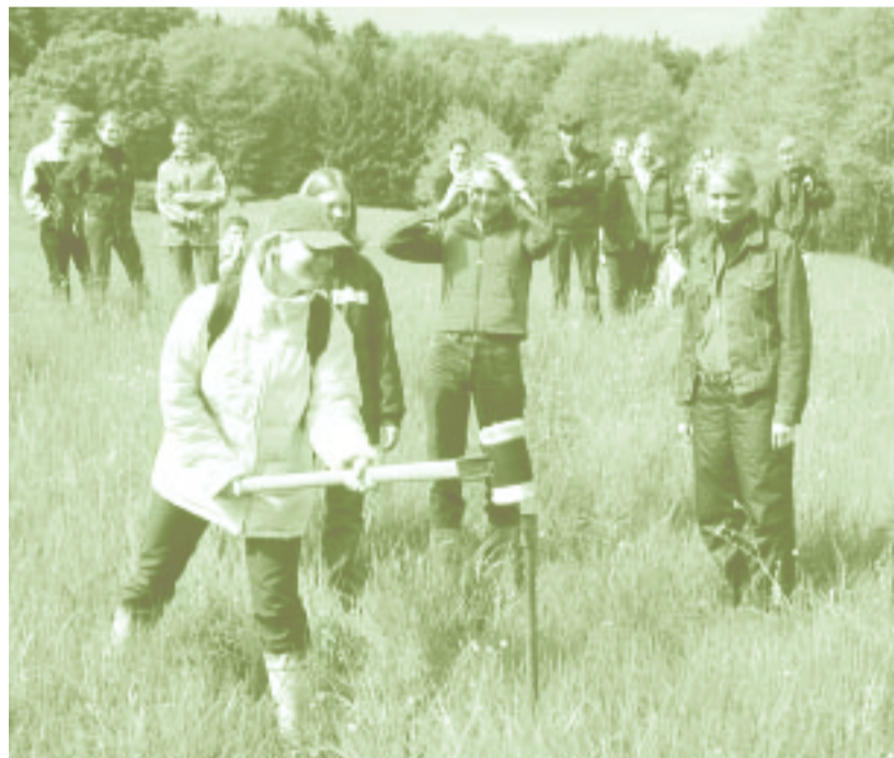
Das ist der Hammer: Schüler der Adolf-Reichwein-Schule in Neu-Anspach am schweren Gerät. Mit dem Pürckhauer-Bohrer gilt es, eine Bodensondierung vorzunehmen.
